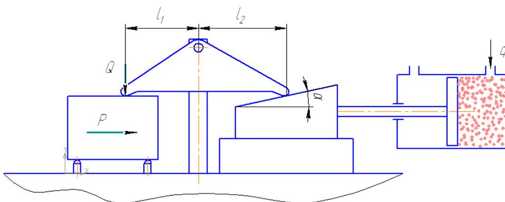
На рисунке представлена схема рычажно-клинового зажимного механизма станочного приспособления. Определить силу  $Q$  на штоке пневмоцилиндра и диаметр пневмоцилиндра, если известна:
