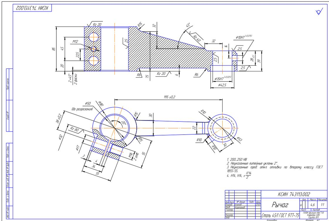
Спроектировать приспособление, предназначенное для базирования и закрепления детали типа рычаг (см.чертеж) из стали 45Л (ГОСТ 977-75) при обработке на многоцелевом вертикальном станке высокой точности 2254ВМФ4 (операция 035, первая позиция). Заготовка рычага получена литьём, масса детали 4,6 кг. Маршрут обработки детали:
