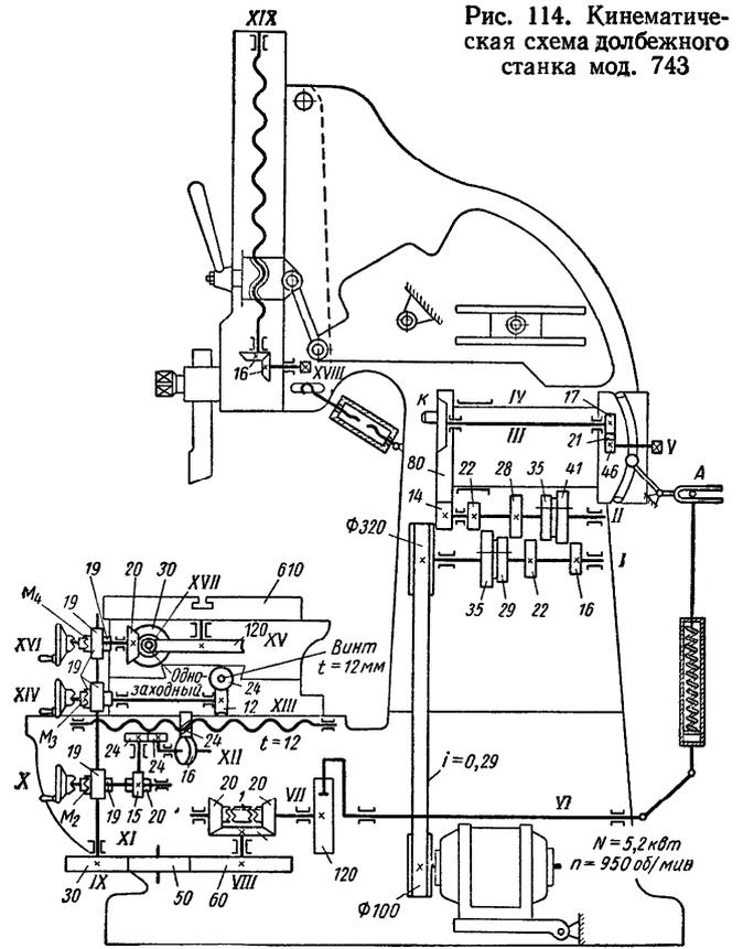
Рис. 114. Кинематическая схема долбежного станка мод. 743
