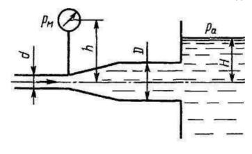
Определить расход жидкости, вытекающей из трубы диаметром d через плавное расширение (диффузор) и далее по трубе диаметром D в бак. Коэффициент сопротивления диффузора  $\xi$ =0,2 (отнесен к скорости в трубе), показание манометра  $p_{\rm M}$ ; высота h; H; плотность жидкости  $\rho$  = 1000 кг/м³. Учесть потери на внезапное расширение, потерями на трение пренебречь, режим течения считать турбулентным.
