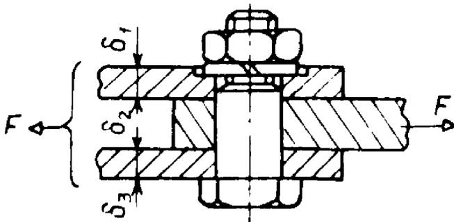
Исходные данные для расчета приведены в таблице, где  $f$  - коэффициент трения. Считать, что затяжка болтов не контролируется, а действующая нагрузка статическая.
